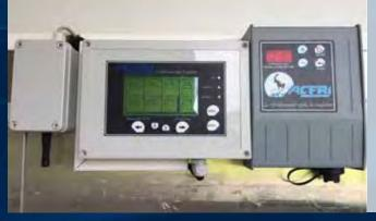
Chaque afficheur permet le pilotage et la traçabilité de 8 chariots. Le boîtier affiche en temps réel température durée du cycle et nom du produit.
